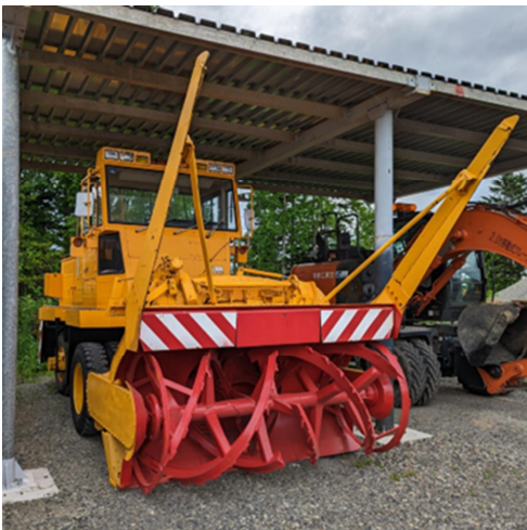
【図表 67】大型ロータリー除雪車の例
