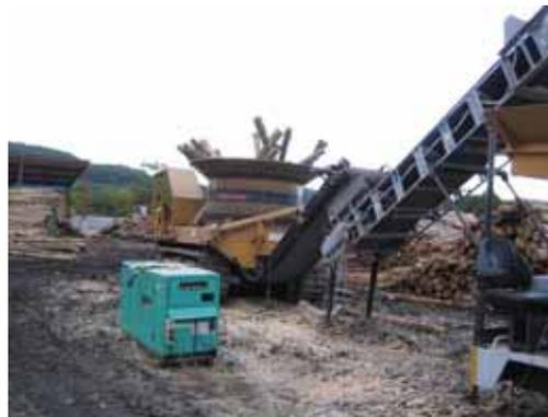
図 5.13 チップ製造設備設置状況
