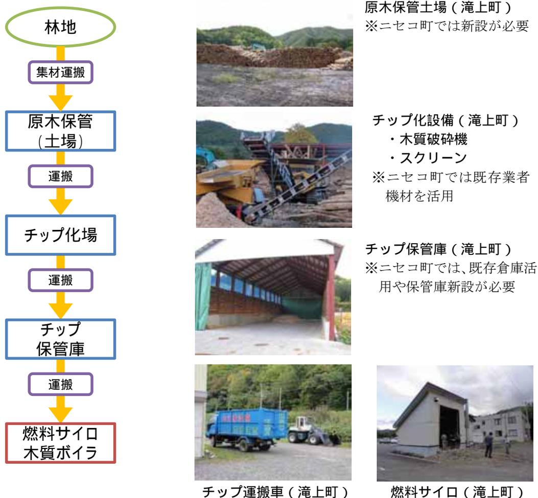
図 4.27 燃料供給過程フロー量
