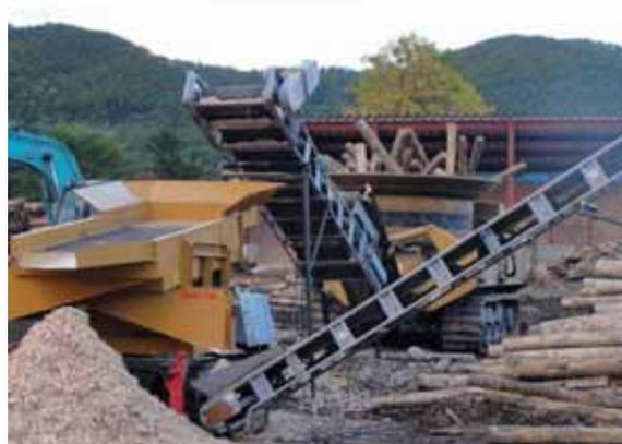
図 4.2 滝上町 木質破砕機とスクリーン
