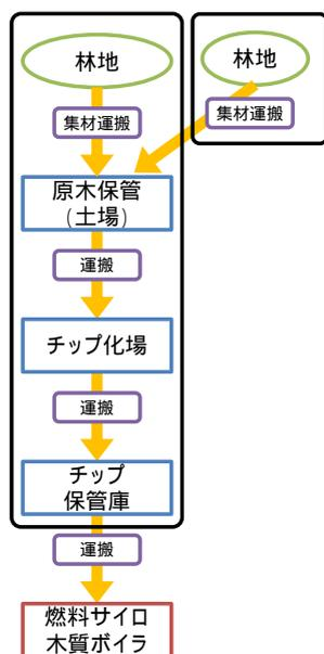
図 4.29 現況チップ製造フロー（実証試験想定）
