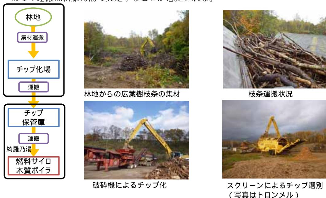
図 4.28 ニセコ町で現状で想定される当初の燃料供給過程フロー
