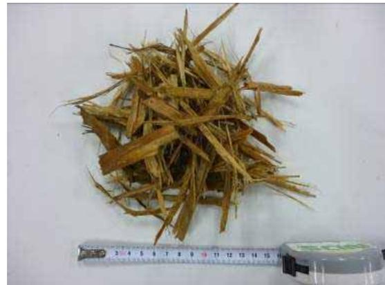
図 4.15 試験地 B (針葉樹追上材、末木) 製造チップ
