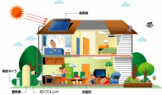
太陽の熱エネルギーを集め給水や冷暖房に利用。システム構成の観点から、一般の住宅に多く導入されている「自然循環型」とビルなどの大規模な施設で導入されている「強制循環型」に分類される。
