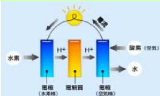
水素と酸素を化学反応させて、直接、電気を発電する装置。燃料電池の燃料となる水素は、天然ガスやメタノールを改質して作るのが一般的。
