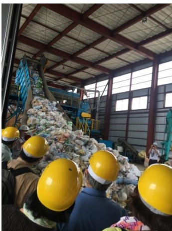
7町村のごみがコンベアによって運搬
