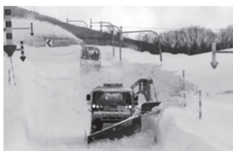
※矢羽根 路肩の道路位置を示す為の矢印状の標識（固定式視線誘導柱）
