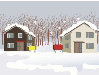
× 落雪箇所に灯油タンクが設置
