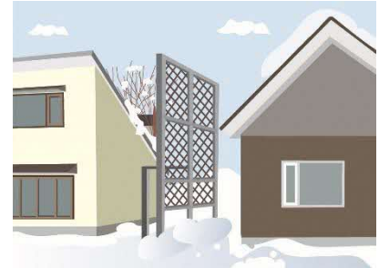
× 落雪防止柵の設置
