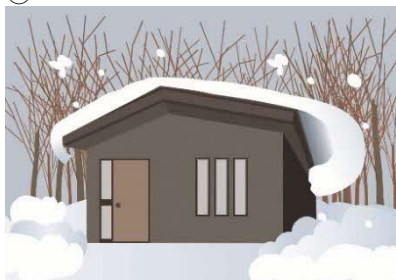
× 不十分な屋根勾配 (巻きだれが発生)
