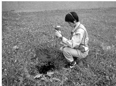
(写真1) 地下に埋設された水道メーターに伝わる振動音で漏水を確認します
