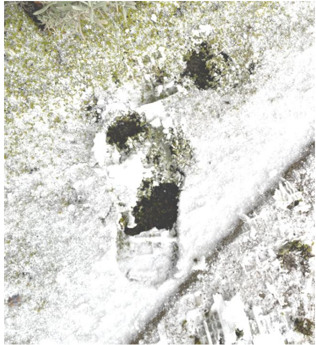
蹴り上げた歩行後の様子 (横方向の力で剥がれる)
