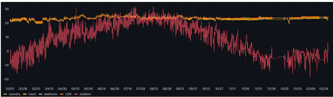
図：体験宿泊に使用した住戸では、自動制御により温度・湿度を制御している。室温最大値は2024年7月15日の27°C（西日がいった瞬間）、最低室温は2024年4月26日7時の21°Cであった。一方の外気温は夏30°Cを超え、冬△15°Cを下回っており、外気温と縦軸（温度）の縮尺を合わせると、室温はほぼ一直線になっているのが分かる
