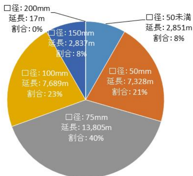
曽我地区水道施設 管路の口径
