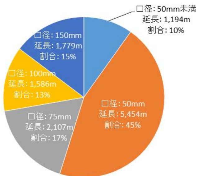
二セコ地区水道施設 管路の口径
