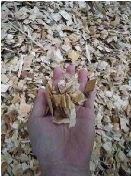
切削タイプのチッパーで作られた チップを使用
