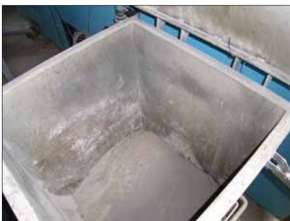
燃焼後の灰は専用ボックスに集積される
