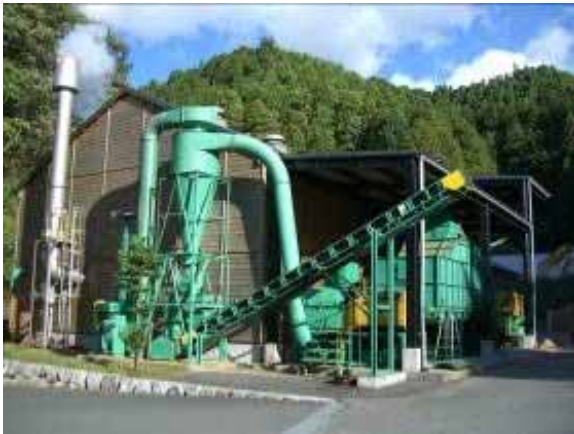
間伐材や端材を搬入し、原料ヤードに貯留。一次破碎機および二次破碎機で細かく砕く。
