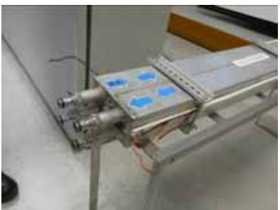
温度差発電の試作機
