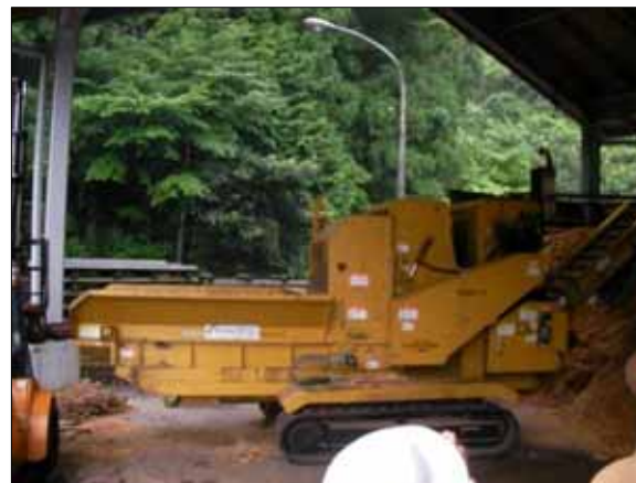
クローラ型の移動式破碎機(チップパー)を使用している
