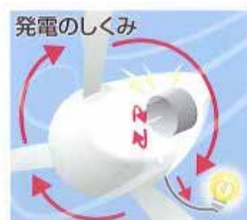
プロペラ型小形風車の発電原理
