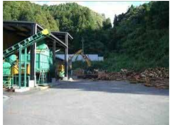
間伐材や端材を搬入し、原料ヤードに貯留。一次破碎機および二次破碎機で細かく砕く。
