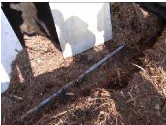
融解水が管を通して循環している
