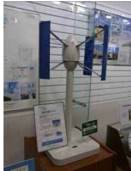
蓄電式小型風力発電装置
