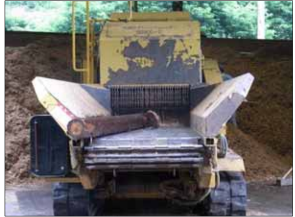
材料はベルトローラーによって破砕に運ばれる
