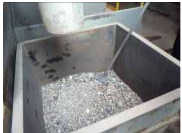
建築廃材に鉄や木くずが混ざっており鉛やクロムが排出される
