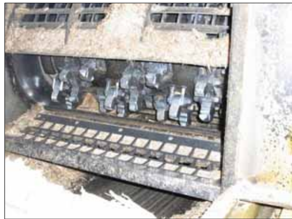
破砕室内部:カッタードラムによって材料を破砕する
