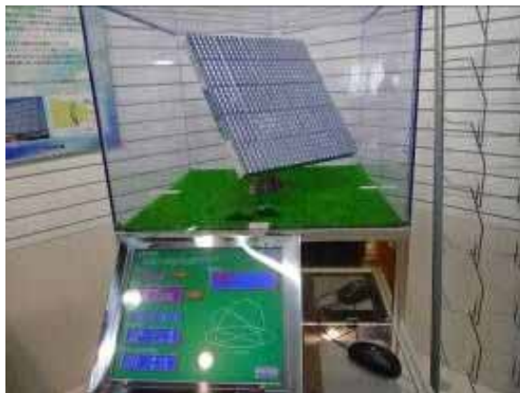
集光式太陽光発電プラントの模型。好きな地域の太陽の動きを入力しシュミレーションすることができる
