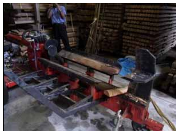
太い材料はこの機械によって分割する
