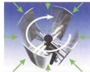
垂直軸風車の回転メカニズム(注)
