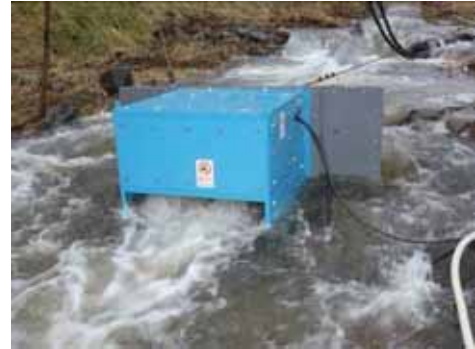
水車の羽根が水没しているが効率よく回転し発電をおこなっている(12/4)
