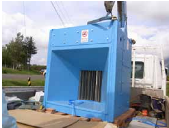
立方体の形状をした流水式発電機
