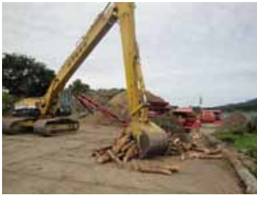
大型チップパーに材料を投入 材料が高速ハンマーで砕かれ、チップとなる
