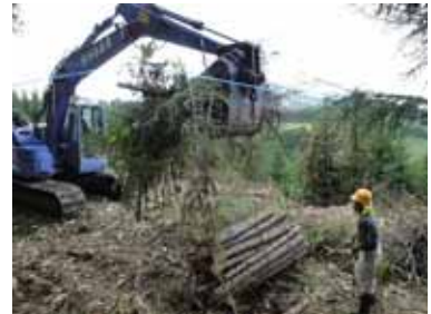
収集した樹木をバックホーで積み込み 枝葉はバケットでつかみ、幹はワイヤーで吊下げる
