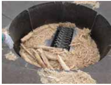
大型チップパーに材料を投入 材料が高速ハンマーで砕かれ、チップとなる
