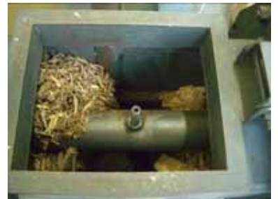
チップ投入口内部
