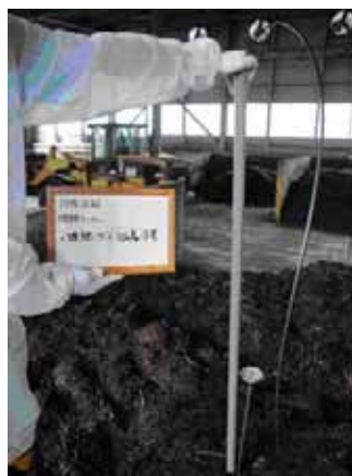
堆肥へ収集管を挿入
