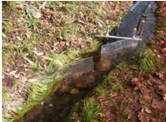
流れに向かって斜めに設置した防塵網
