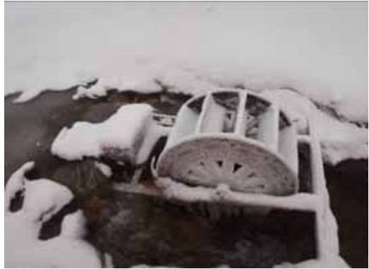
水車本体に着氷・着雪が見られ回転が停止して
