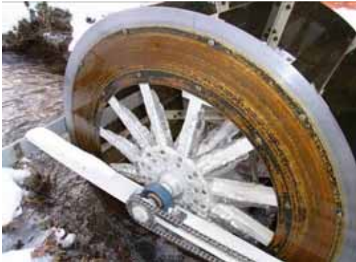
水車主軸とスポーク部の着氷がみられる
