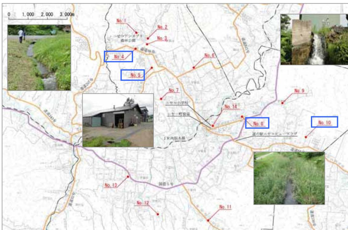
前頁で検討を行った実測調査の比較表から次の4つの場所を選定した。「No.4」の二セコアンヌプリに向かう交差点付近を流れる農業用水路、「No.5」大道農場倉庫横を流れる農業用水路、「No.8」有島記念館駐車場横を流れる第二カシュンベツ川、「No.10」竹内農場内を流れる農業用水路を利用し、マイクロ水力発電機の実証実験を行う。
