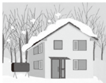
× 落雪箇所に灯油タンクが設置
