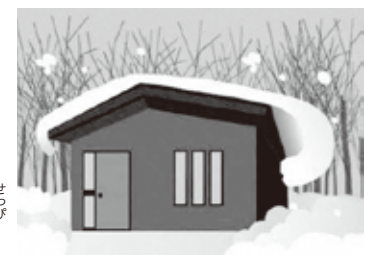
× 不十分な屋根勾配（巻きだれが発生）
