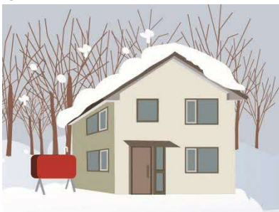
× 落雪箇所灯油タンクが設置
