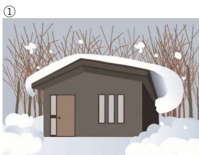
① × 不十分な屋根勾配 (巻きだれが発生)
